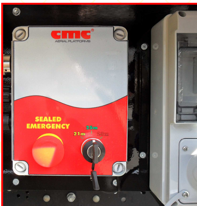
Bild 21 - Kasten des Unterchassis mit verplombten, pilzförmigen Notknopf
