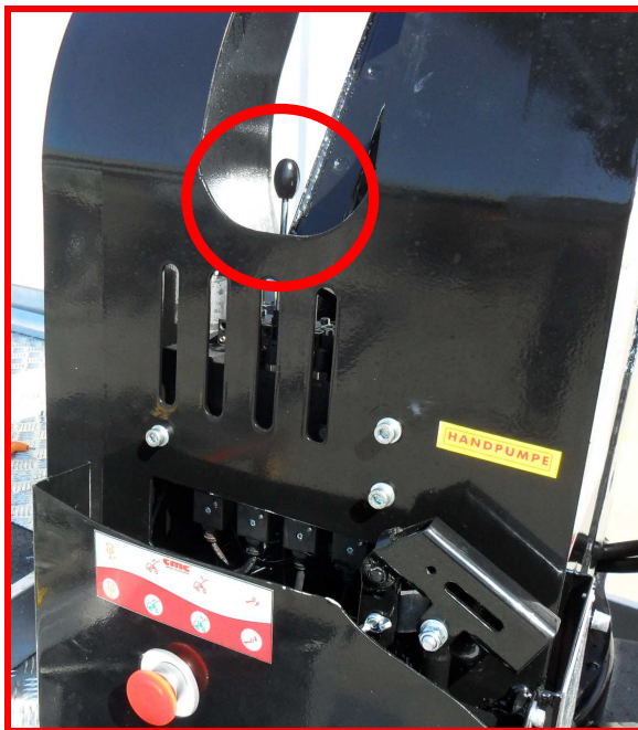
Bild 23 – Erste Bewegung mit heruntergedrücktem Hebel: TELESKOP WIRD EINGEFAHREN
